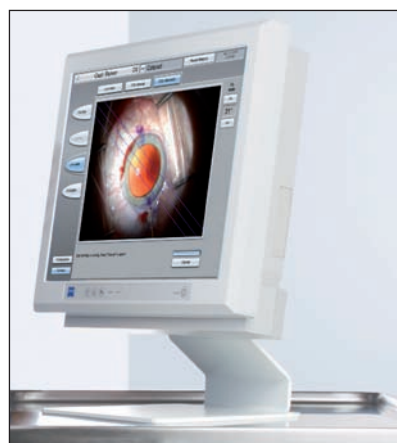
Figure 3. Callisto : aide au repérage de l'axe d'implantation assistée par ordinateur.
