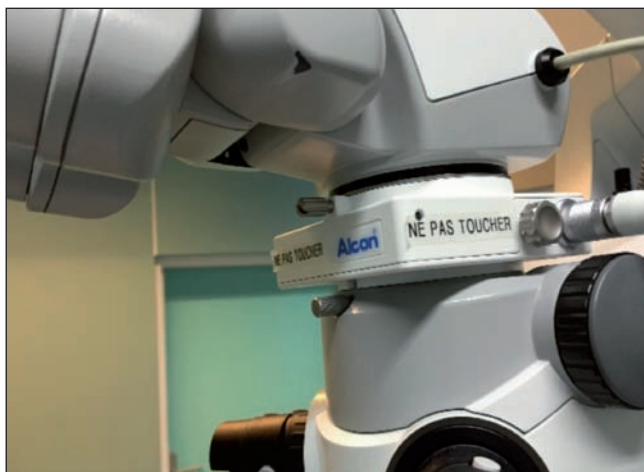
Figure 2. Connexion du marqueur numérique au microscope opératoire par l'intermédiaire d'une « bague » insérée dans la colonne du microscope.
