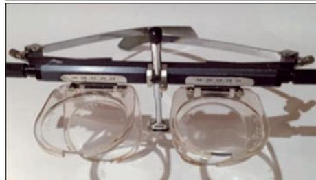
**Figure 6.** Lunettes d'essai utilisées pour les essais comparatifs de géométries de verres progressifs.
