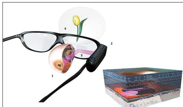
**Figure 2.** Principe de fonctionnement du système PRIMA : l'implant sous-rétinien (1) est stimulé par émission d'un faisceau laser (2) transmis à travers les lunettes (3) et représentant l'image capturée par la caméra fixée sur les lunettes (4).
