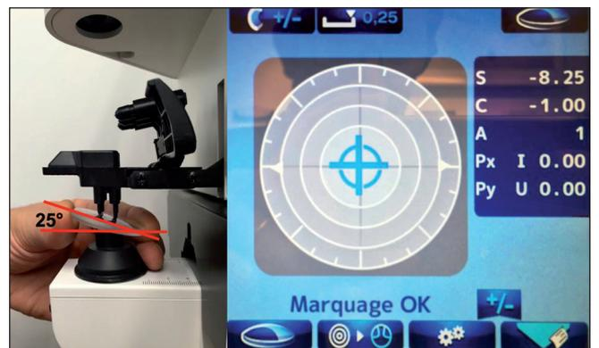
**Figure 4.** Verre fort indice ( $n = 1,74$ ) asphérique  $-8,00 D$ , inclinaison 25°. Incidence sur la correction portée.
