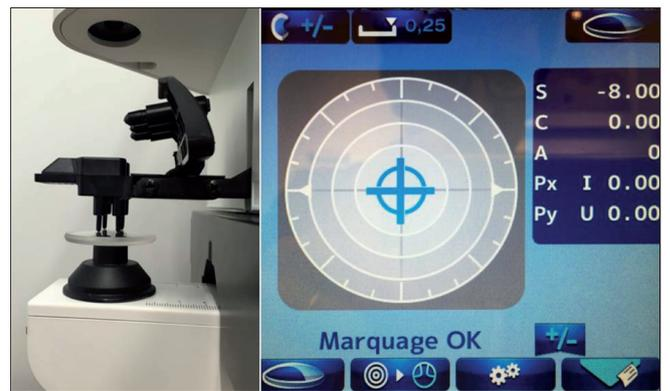
**Figure 3.** Verre fort indice ( $n = 1,74$ ) asphérique  $-8,00 D$ , inclinaison nulle. Pas d'incidence sur la correction portée.
