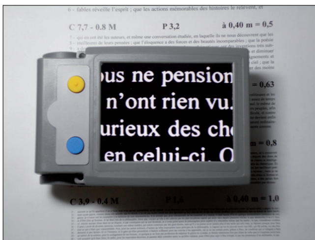
Figure 3. Loupe électronique : la taille limitée de l'écran impose un déplacement de l'instrument réglé par la vitesse de lecture.
