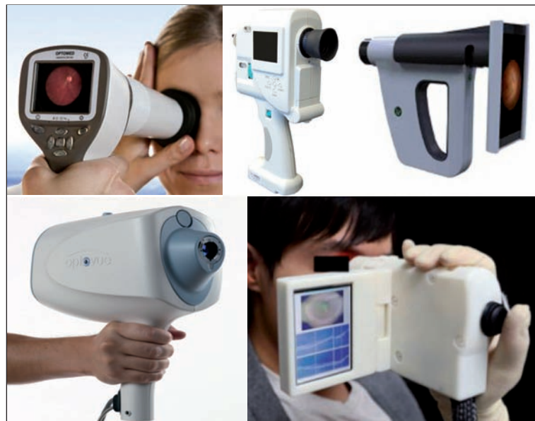
Figure 4. Rétinographes non mydriatiques (en haut : Optomed, Kowa, Remidio) et OCT portables (en bas : Optovue, MIT).
