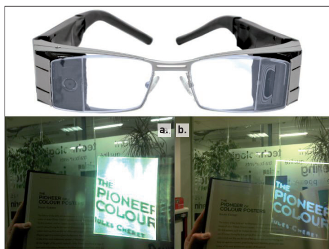
Figure 1. Lunettes à réalité augmentée de la société Essilor. Exemples d'utilisation : a. Image agrandie, contraste et luminosité augmentés. b. Inversion de couleur : blanc sur noir.
