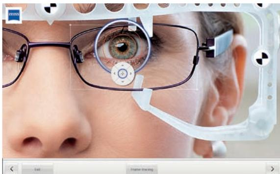
L'appareil fournit toutes les données nécessaires tels que les demi-écarts pupillaires, les hauteurs, l'angle pantoscopique, l'angle de galbe, la distance verre-œil et aide également l'opticien et le porteur dans le choix de la monture. Le Groupe Carl Zeiss AG a également présenté ses résultats annuels pour l'exercice 2010-2011, avec un chiffre d'affaires en hausse de 10 %, à 4,237 milliards d'euros. ■
