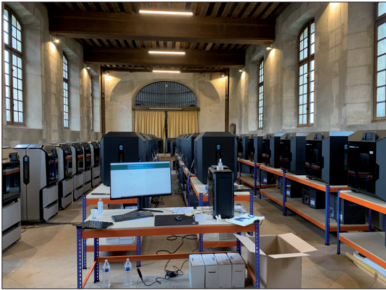
Figure 2. Ferme d'imprimantes 3D pour la production de consommables et de pièces détachées (hôpital Cochin).
